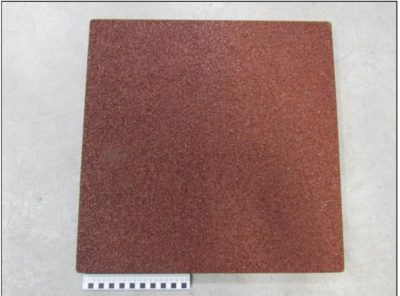
Loseta de caucho rojo (500 x 500 x 40)mm
