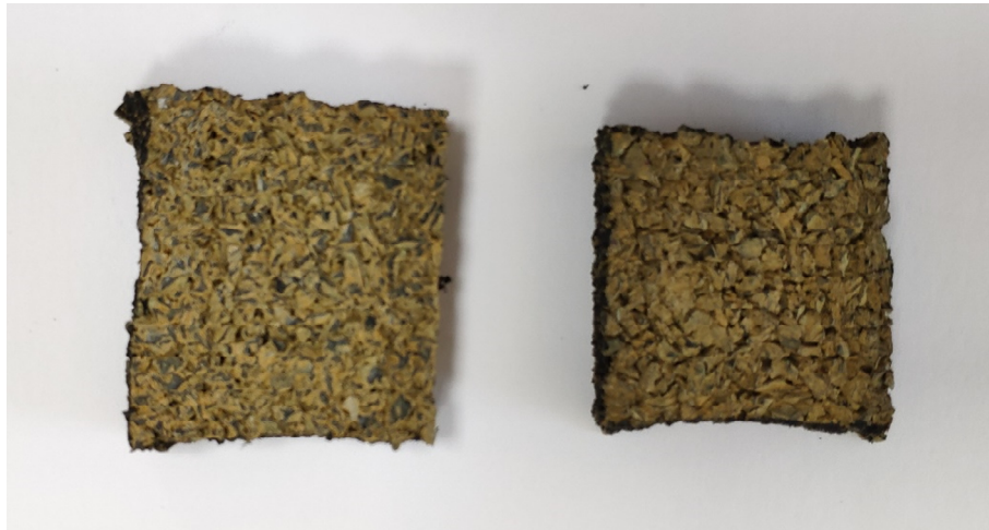
FIGURA 3. MUESTRA REF. "LOSETA OCRE", IZQ.) SIN ENVEJECER, DER.) TRAS 1500 HORAS DE ENSAYO
