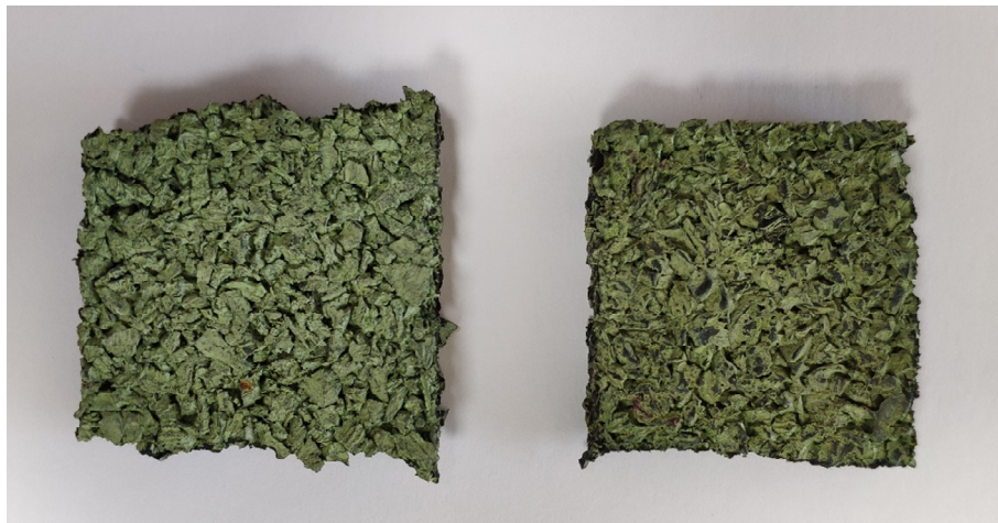
FIGURA 1. MUESTRA REF. "LOSETA VERDE", IZQ.) SIN ENVEJECER, DER.) TRAS 1500 HORAS DE ENSAYO
