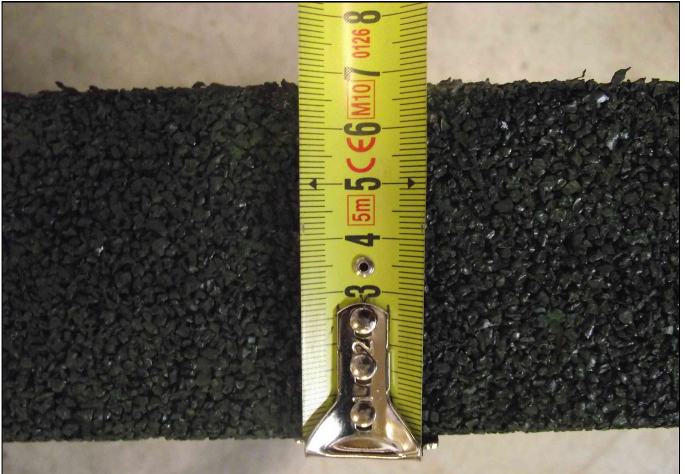
Superficie sintética de caucho (1000x500x70) mm color verde
